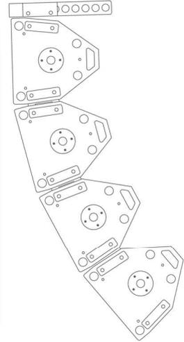
**Difusor rotable y regulación variable en el ángulo vertical para posición "LINE ARRAY".**
